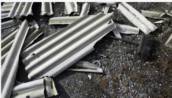
A Asbestgolflaten. © Bram Saays / HH
